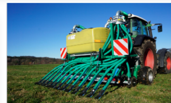
Versuchstechnik für unterschiedliche Gülleausbringung in wachsende Bestände: Schleppschlauch/-schuh bzw. Schlitztechnik
