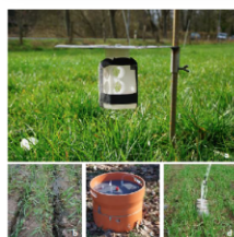
(a) Passivsammler, (b) Gülleinjektion mit Scheibenschlitz, (c) \text{N}_2\text{O} Messhaube, (d) Dräger-Tube Methode
